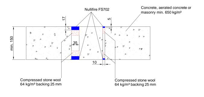
Wall thickness min. 150 mm
