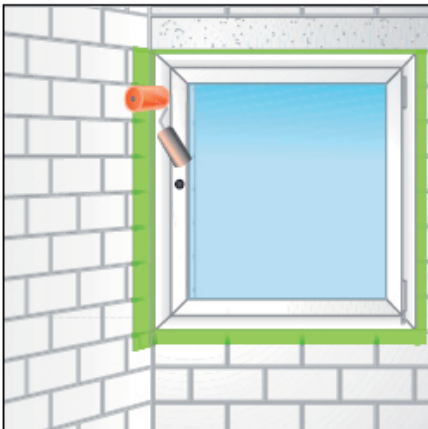
Obr. 6: Fólii důkladně přitlačte válečkem
